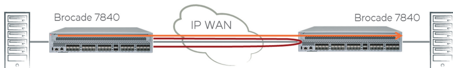
Рис. 48. Использование технологии Flow Vision совместно со встроенным в Brocade7840 генератором трафика позволяет заранее протестировать необходимые характеристики канала и убедиться в его соответствии необходимым требованиям.
