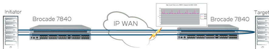
Рис. 47. Использование функционала MAPS и Fabric Vision позволяет автоматически определять узкие места и находить причину медленной работы в сети хранения данных, что ускоряет поиск ошибок и позволяет избежать внеплановых остановок.
